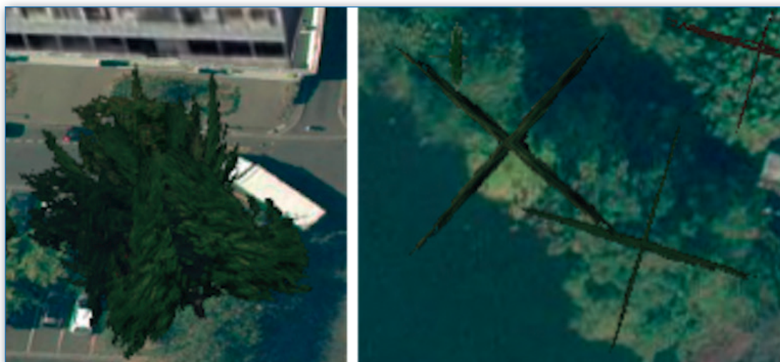
Figure 1 : Représentation de type billboard (ou « croisillon ») texturé des arbres.
