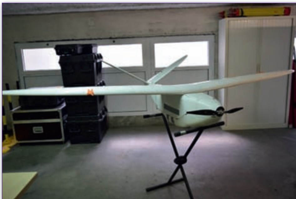
Le DT26 de chez Delair, autre drone phare d'Altamétris, permet de voler avec un LiDAR pendant plus d'une heure.
