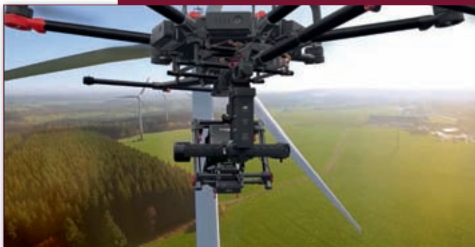
Exemple d'intégration d'une caméra Phase One avec un drone de type multicopter. Document Phase One .
