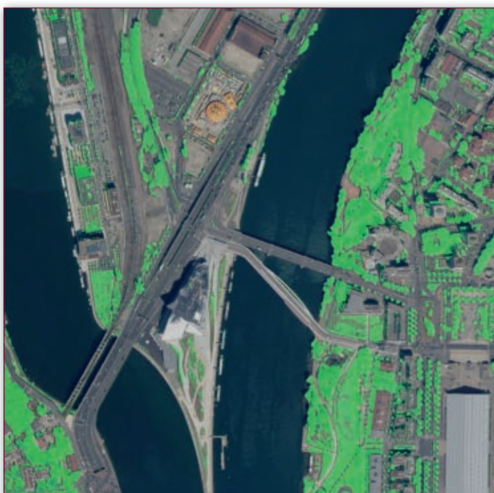
Superposition de l'image obtenue en calculant l'index NDVI, colorée en vert et de l'image en couleurs naturelles. Tous les pixels vert « flashy » peuvent être considérés comme des zones de végétation (NDVI important).
