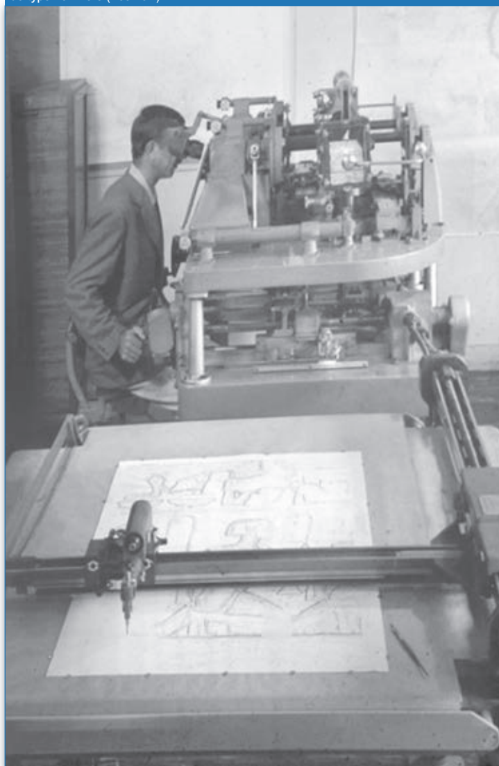
Un employé de l'IGN procède à la stéréo-restitution d'une série de clichés sur un appareil de type Poivilliers (Doc. IGN).
