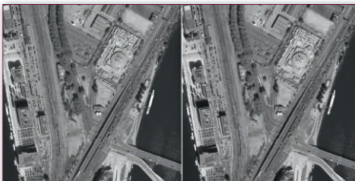
Deux images panchromatiques obtenues en mélangeant les bandes de l'image en couleur naturelle. À gauche, la luminance est simplement la moyenne des composantes rouge, vert, bleu de chaque pixel. À droite, la luminance est pondérée en fonction de la sensibilité de l'œil aux différentes couleurs. La différence entre les deux images est visible, mais subtile.
