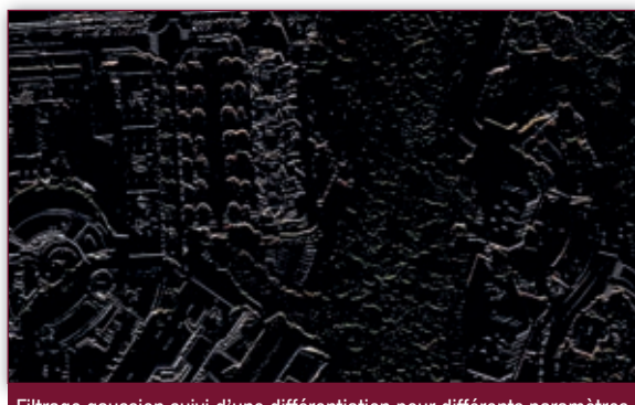
Filtrage gaussien suivi d'une différentiation pour différents paramètres de la gaussienne. L'intensité du filtrage augmente du haut en bas. L'image du haut, trop bruitée, est inexploitable. L'image du bas, trop filtrée, l'est également. Il est difficile de trouver un juste milieu.
