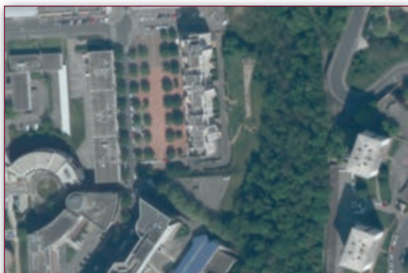
Même image, traitée aux filtres moyenne et médian de sept pixels. Le rendu diffère, quoique l'algorithme soit quasiment identique.
