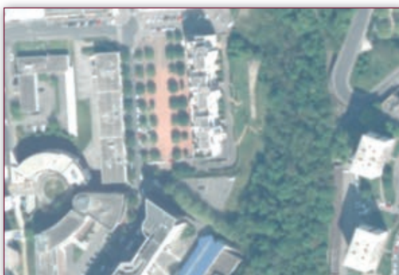
Trois exemples de filtrage passe-bas gaussien, sur une grille de neuf pixels. En haut, la variance est à un pixel, trois au milieu, sept en bas. On voit bien que le flou augmente. Les images ont été corrigées, mais il est clair que la dynamique diminue lorsque le flou augmente, puisque les détails très lumineux ou très sombres sont « gommés ».
