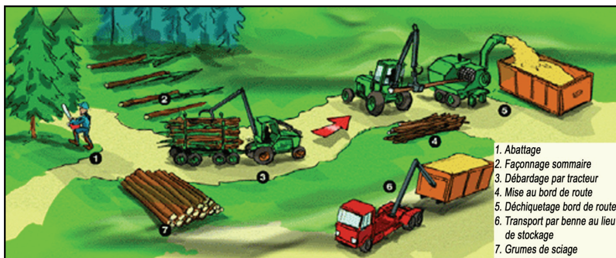
Figure 4 : processus de production de la plaquette forestière
