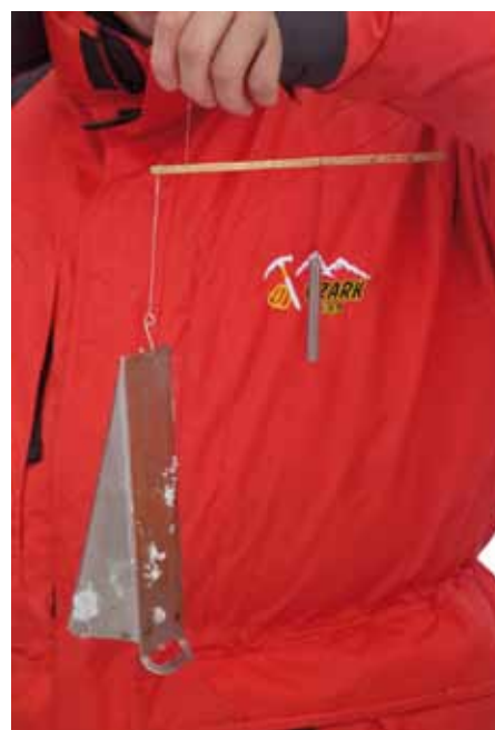
Figure 200 – Le système chinois de peson pour estimer la densité du manteau neigeux.
