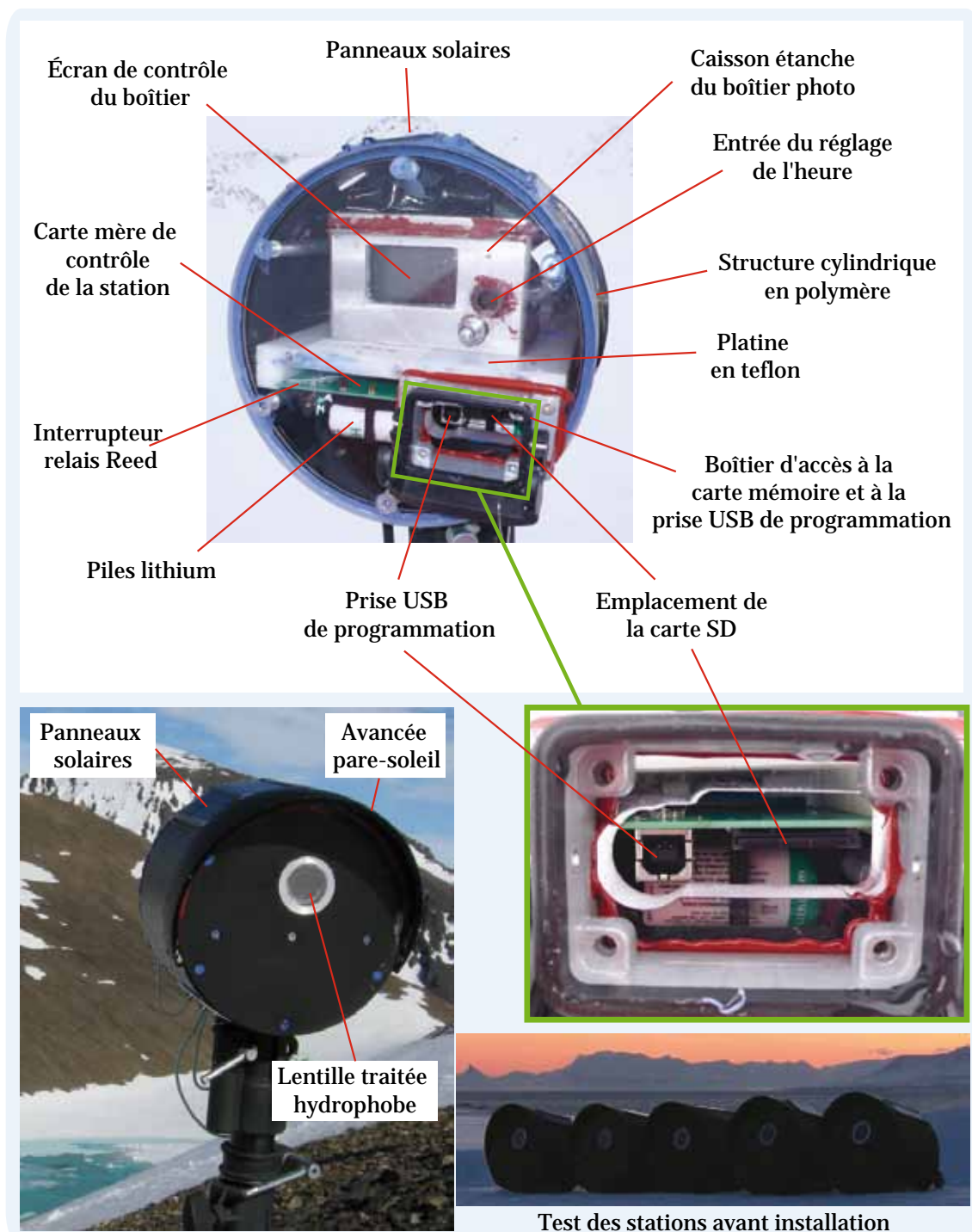
Figure 92 – La station photo automatique de 3 e génération. Ce système, complexe dans sa conception, est adapté aux conditions difficiles de l'Arctique et dispose d'une autonomie qui lui permet un fonctionnement sans intervention humaine pendant la majorité de l'année.
