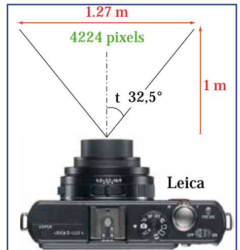
Figure 93 – Les caractéristiques de calibration de l'appareil photo utilisé.
