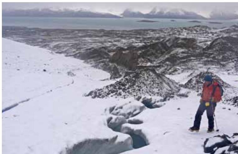
Figure 71 – Opérations de détournement des limites du front du glacier au DGPS. Ces campagnes permettent de déterminer pour chaque année hydrologique la position du front et d'en déduire l'espace gagné ou perdu par le bassin versant de la moraine (photo : D. Laffly – campagne d'octobre 2009). L'automne permet d'identifier la limite à la fin de l'année hydrologique, mais parfois, même sur le terrain, le doute subsiste : où s'arrête vraiment le front ?
