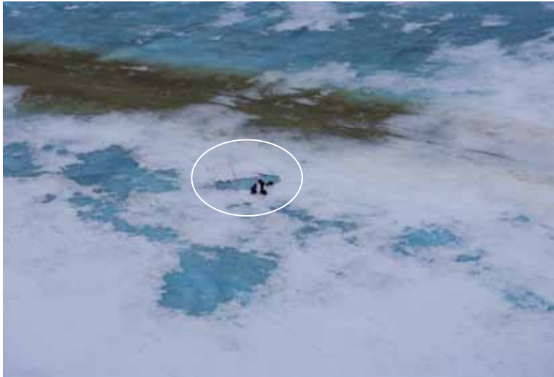
Figure 116 – Relevé des balises à glace. Seule une petite zone où est située la balise se trouve en ablation, alors qu’une vaste périphérie est a priori en accumulation (photo, Ch. Morel, automne 2008, projet Our Polar Heritage).
