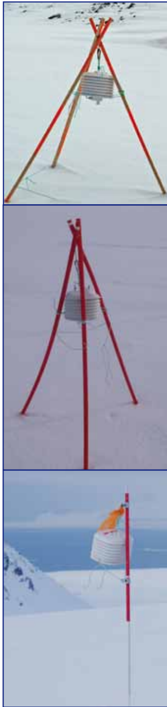
Figure 83 – L'évolution du mode de fixation des capteurs permet actuellement de les garder hors de la neige pendant toute l'année. Après plusieurs tâtonnements, la solution consistant à implanter un monopode en aluminium semble aujourd'hui la plus fiable.
