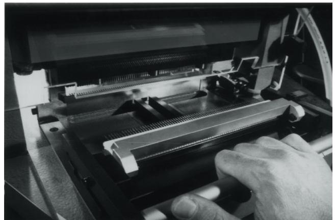
Outillage de séparation des contre-électrodes de tête d'imprimante électrostatique 600 volts. Cliché Cabinet Norm.
